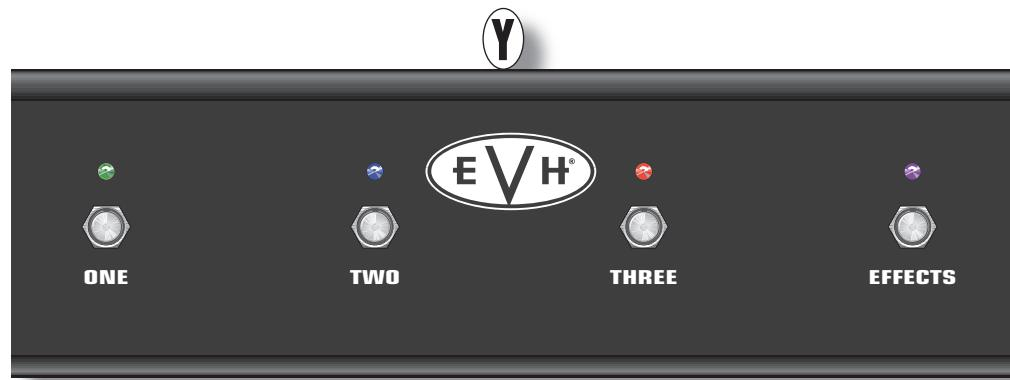
**Y. EVH FOOTSWITCH (EVHフットスイッチ)** - 3つのチャンネルと、エフェクト・ループの選択に使用します。各チャンネルに割り振られたLEDの色（緑／青／赤）は、それぞれアンプリファイアーフロントパネルと同じ色となっています。
