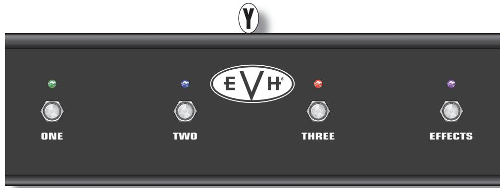
**Y. PÉDALIER EVH**—Le pédalier permet de sélectionner rapidement l'un des trois canaux et la boucle d'effets. Les Leds verte, bleue et rouge correspondent aux Leds des canaux sur la face avant de l'amplificateur. Elles s'allument lorsque leur canal respectif est sélectionné.
